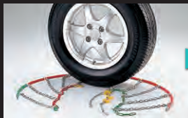
ケーブルをタイヤの裏側に通します。
